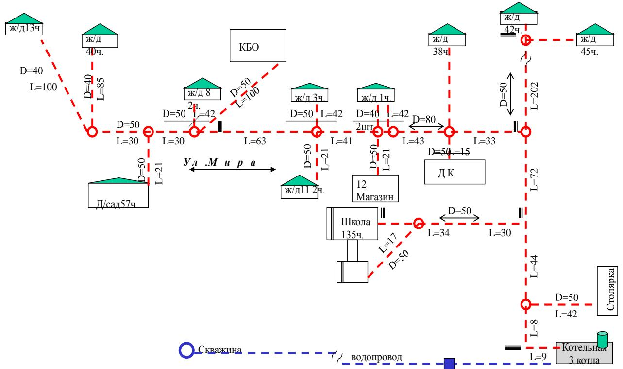
**Рис. 4. Схема тепловых сетей котельной с. Новопокровка
